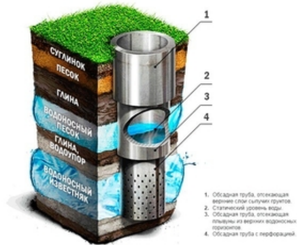
Конструкция артезианской скважины
