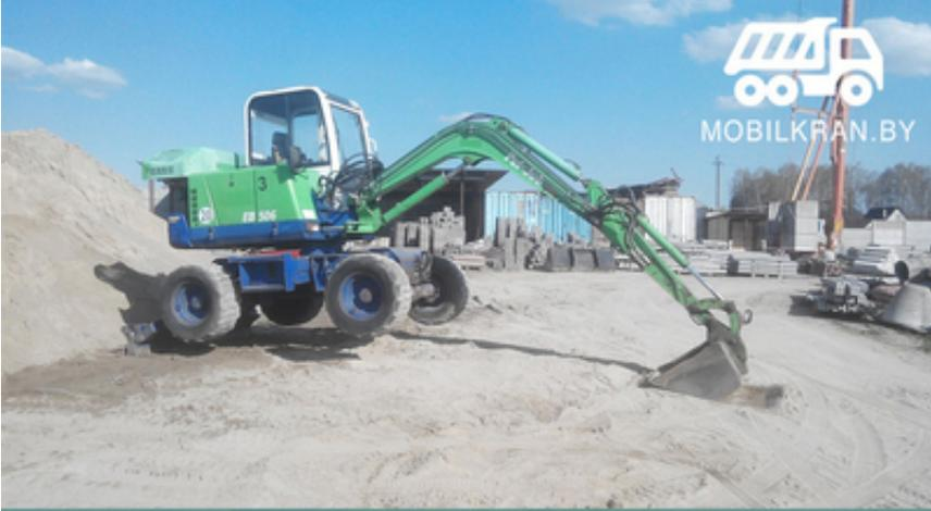
**ЭКСКАВАТОР КОЛЕСНЫЙ** полноповоротный
